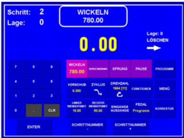
Nach dem Wickelvorschrift man ordnet einfach zu jedem Schritt entsprechende Lagenummer an. Natürlich auch mehrere hintereinander Schritte können gleiche Lagenummer angeordnet haben. Wie wir dieses Anordnen einprogrammieren, so wird es beim Wickeln gebildet.
