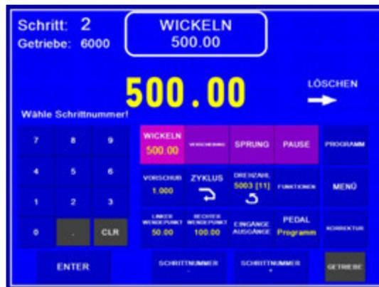
Das Wickeln ist nur in diesen zwei Fenstern erlaubt. Wenn beliebiges anderes Fenster geöffnet ist, Start des Zyklus wird blockiert.
