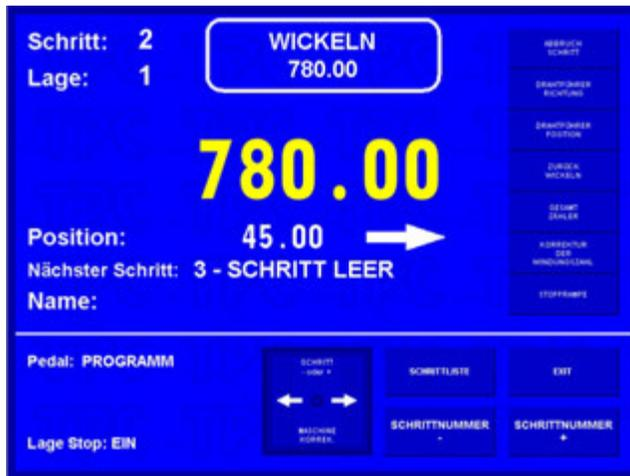
Maximaler Wert der Korrektur der Drahtführerlage darf nicht  $\pm 10$  mm von seiner Lage nach dem Wickeln überschreiten. Größere Korrekturwerte werden nicht durchgeführt werden !
