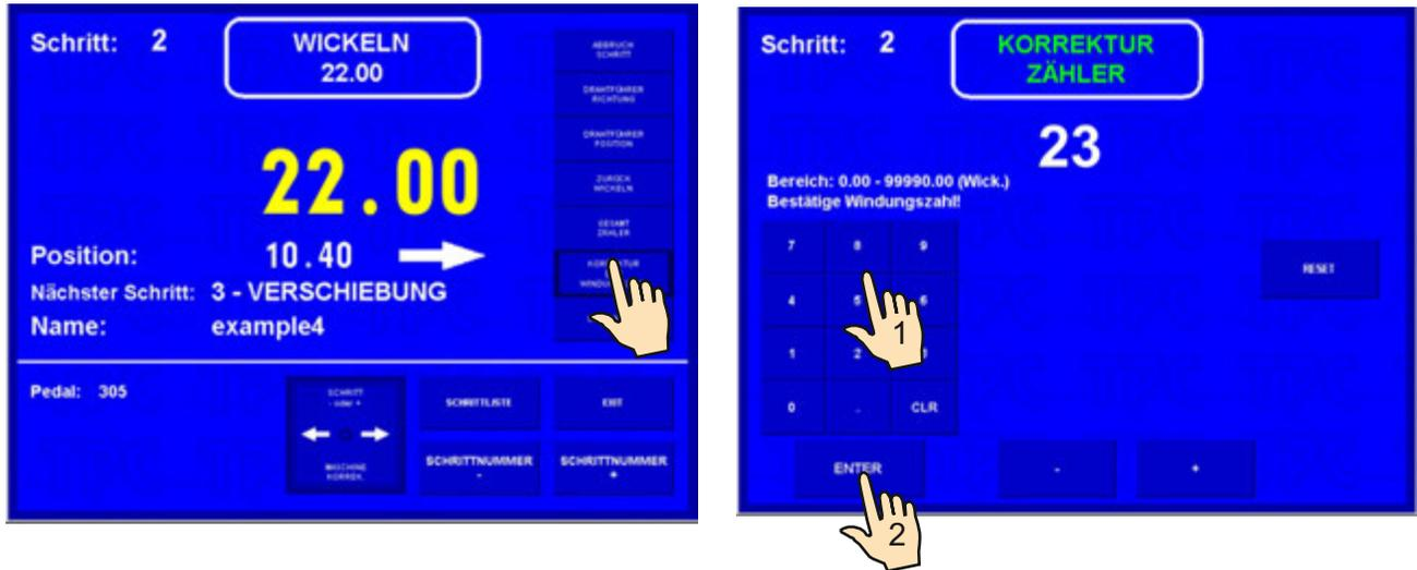
Durch Drücken der RESET - Taste man nullt der aktuelle Zählerzustand.
