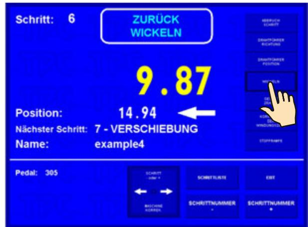
Jetzt können wir mittels Pedal geforderte Windungszahl abwickeln, wobei Windungszahl auf der Anzeige abgerechnet wird und Drahtführer kehrt sich zurück.
