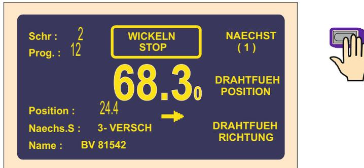
Die Frührückkehr in den Zustand RUHE erfolgt durch Drücken der Taste ABBRUCH.
