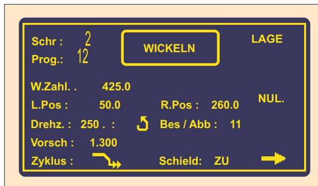
Das Wickeln ist nur in diesen zwei Fenstern erlaubt. Wenn beliebiges anderes Fenster geöffnet ist, Start des Zyklus wird blockiert.
