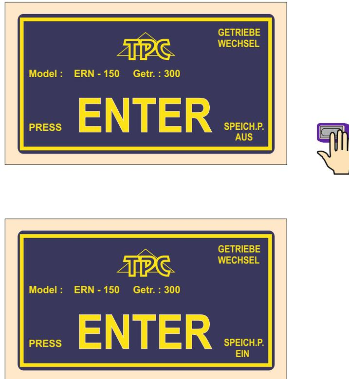
Wenn man diese Funktion einschaltet (SPEICH.P.EIN), die Einleitungseinstellung wird nicht auf Nullwerte eingestellt, sondern auf gespeicherte Werte beim Stromausfall.
