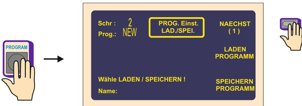
Nach dem Programmschöpfen empfehlen wir Programm zu nennen (Name, Wickelvorschrift). Das sichert den Überblick und schnelle Orientierung in gespeicherten Programmen. Max. Buchstabenanzahl ist 24. Wenn Programme auch auf USB-Schlüssel gespeichert werden, man empfiehlt max. Namenlänge in Format 8.3 - 3 Zeichen, Punkt und Beilage bis 3 Zeichen.
