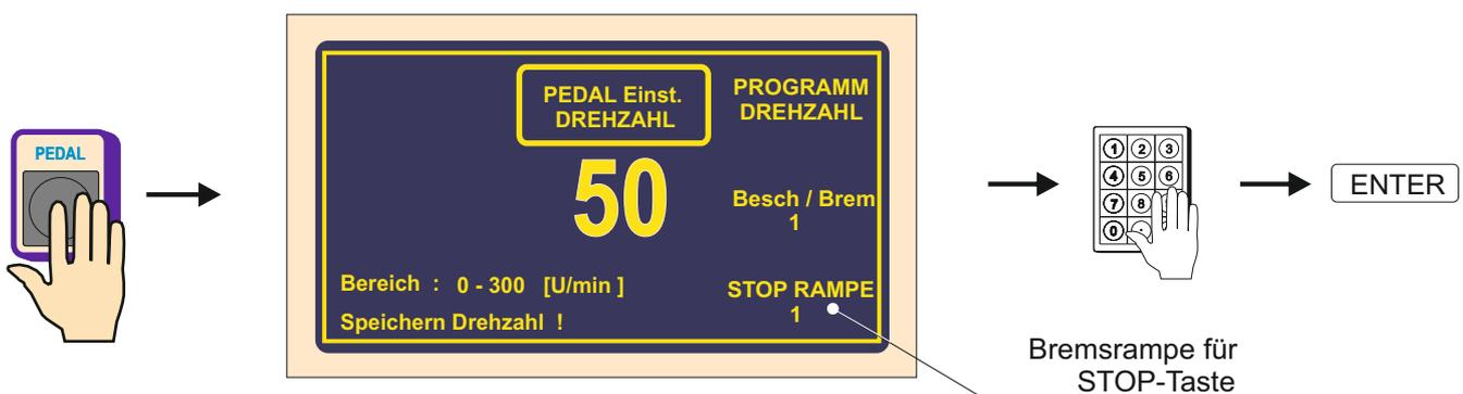
So eingestellte Drehzahl gilt für aktuellen Block (Programm) und hängt nicht von der einprogrammierten Drehzahl in einzelnen Schritten ab. Z.B. Pedaldrehzahl kann auf andere Drehzahl eingestellt werden (meistens niedrigere) als in der Maschine einprogrammierte maximale Drehzahl.
